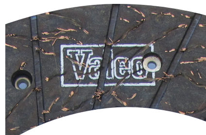
Špeciálne obloženie s nízkym koeficientom opotrebenia vyvinuté pre spojky HEC.
